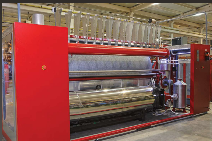
Sistema di riscaldamento a gas
